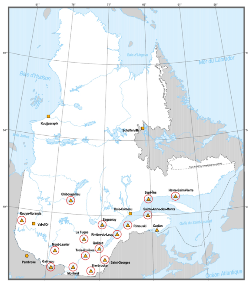
Stations de référence GPS avec un rayon de 30 kilomètres pour celles permettant le positionnement instantané
